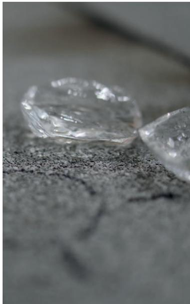
possibles qu'avec un essai AEAI. C'est pourquoi la société swisspor SA a décidé de faire tester la résistance à la grêle de ses lés d'étanchéité en bitume polymère en essai système AEAI. Le système se compose d'une étanchéité bitumeuse double couche classique placée sur une isolation thermique EPS.
